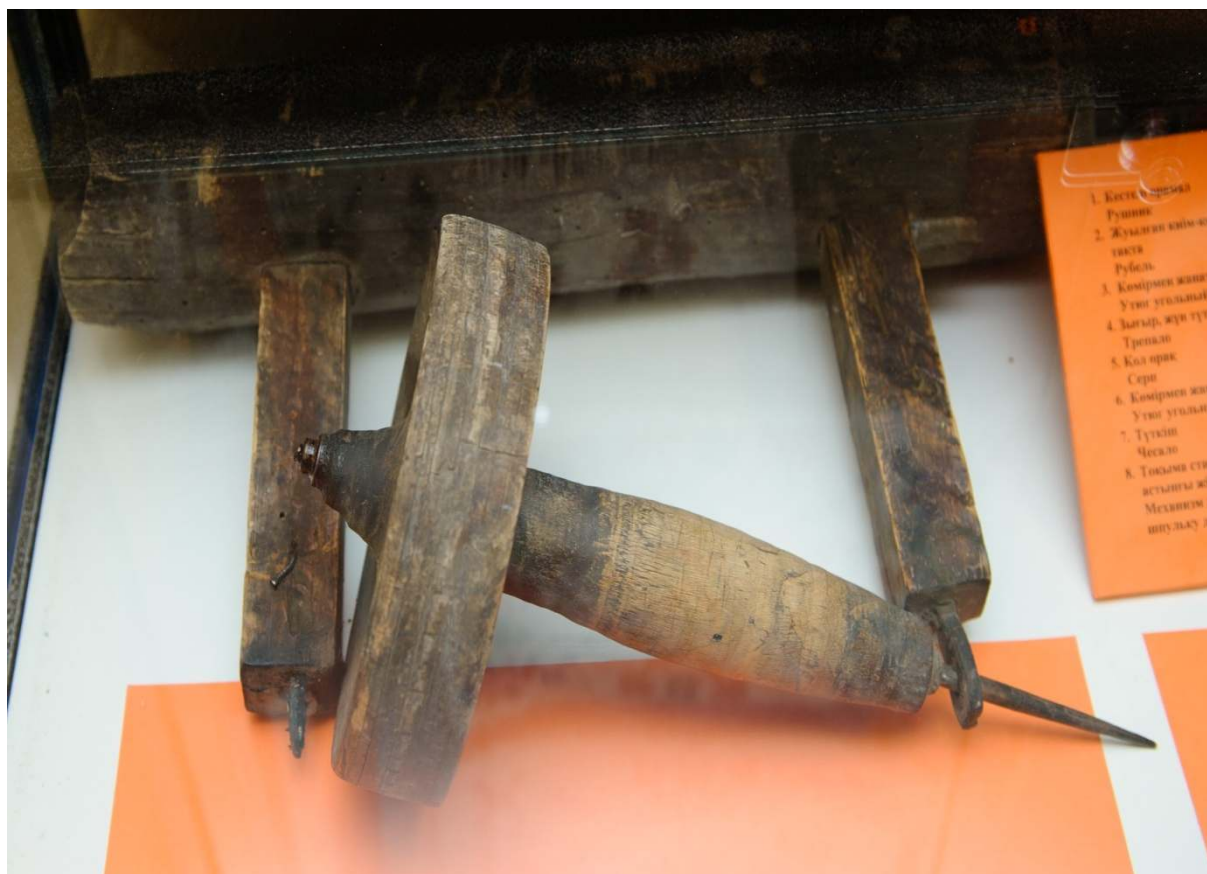
Механизм для наматывания нитки на шпульку для ткацкого станка.
