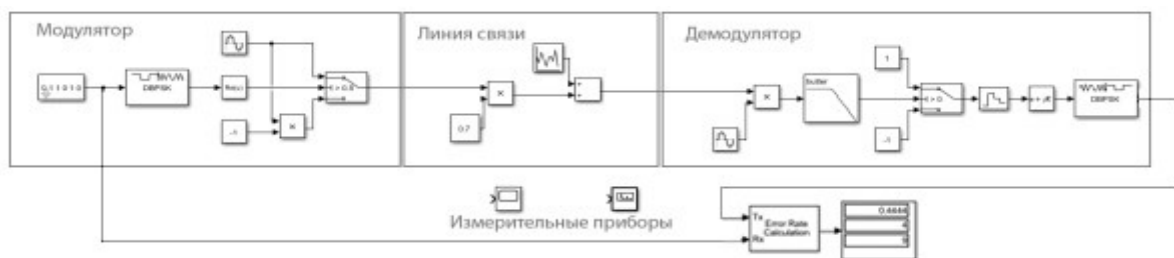
Рисунок 2. Структурная схема моделирования модема ОФМн в среде Simulink.
