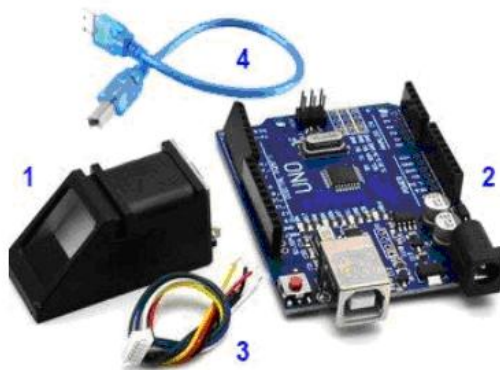
Рисунок 1. Сканер отпечатков пальцев: оптический сканер отпечатков пальцев 1 – TZT AS608; 2 – Arduino UNO; 3 – провода для подключения сканера к Arduino; 4 – USB-кабель для Arduino
