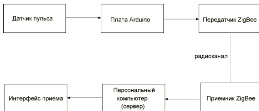
Рисунок 2 – Структурная схема дистанционной передачи пульса с помощью технологии ZigBee
