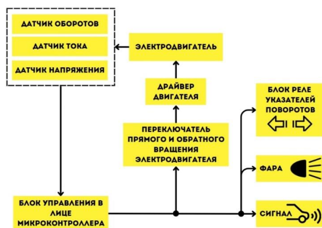
Рисунок 2 – Структурная схема блока управления электромобиля, основанная на микроконтроллере
