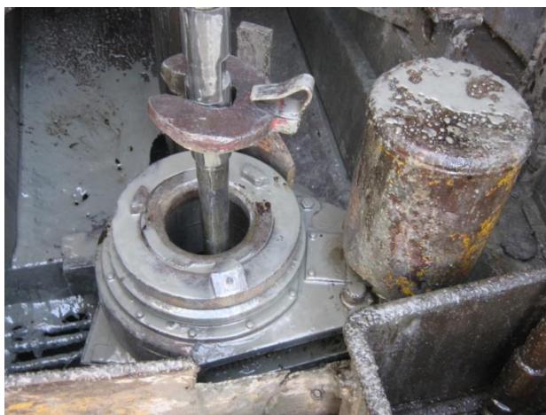
Рисунок 2 – Трубозащитное устройство со снятой боковой крышкой
