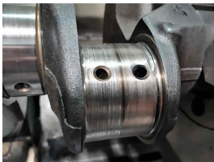
Рисунок 1– Износ шейки коленчатого вала
