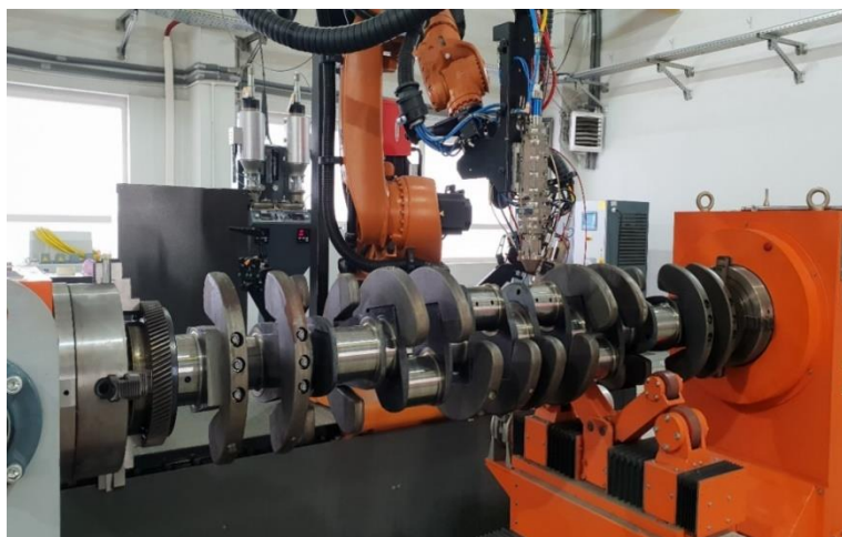
Рисунок 2– Пример выполнения восстановительных работ лазерной установкой
