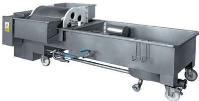
Рисунок 1. – Барабанный фильтр FBN–280 производства “Metalbud Nowicki” (Польша)
