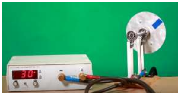
Рисунок 1. – Подшипниковый двигатель с источником питания
