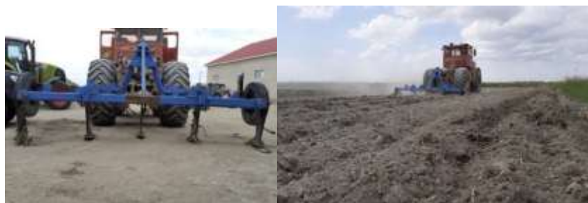
Сурет 1. –Терең өңдейтін чизель–культиваторы және онымен егістік топырағын өңдеу
