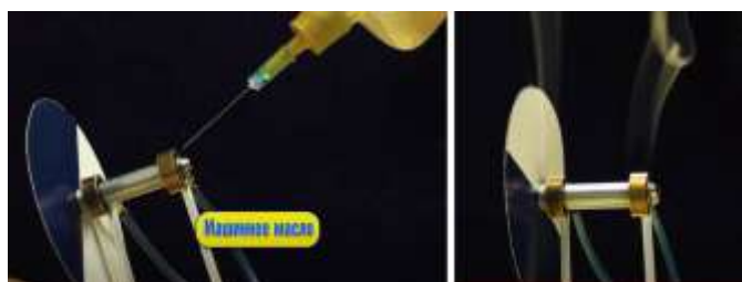
Рисунок 5. – Смазывание автомобильным маслом и остановка двигателя
