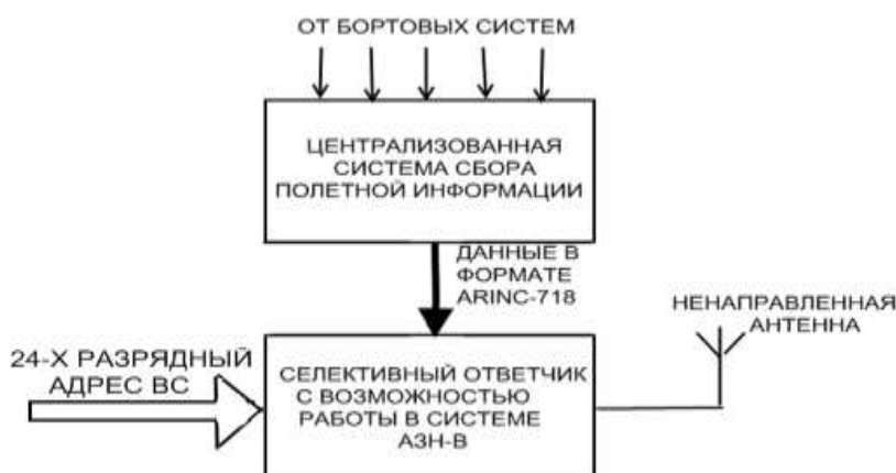
Рисунок 1. – Бортовая часть система дистанционного контроля параметров воздушного судна
