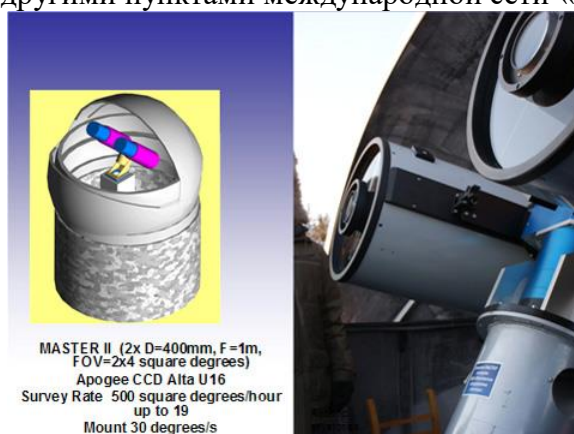
Рисунок 3. Основной элемент проекта – роботизированный телескоп «Мастер – 2»
